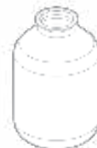
Мембрана гидроаккумулятора (стр. 178)
